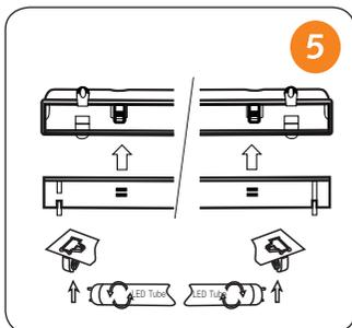
5. Befestigen Sie die Stahlträgerplatte mit den Schmetterlingsklammer am Lampenboden.
