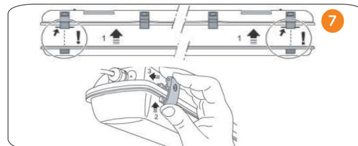
7. Verschließen Sie die Lampe mit dem Deckel. Stellen Sie sicher das alle Clips und die Kabeleinführung richtig verschlossen sind.
