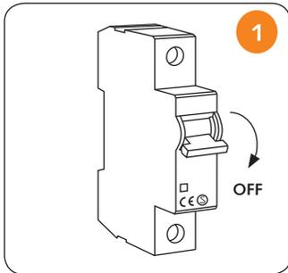
1. WARNUNG! Schalten Sie die Stromzufuhr vor der Installation bzw. Wartung aus.
