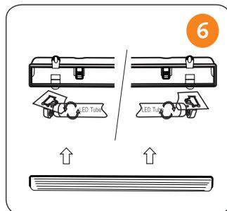
6. Installieren Sie die Röhre in der Stahlträgerplatte.
