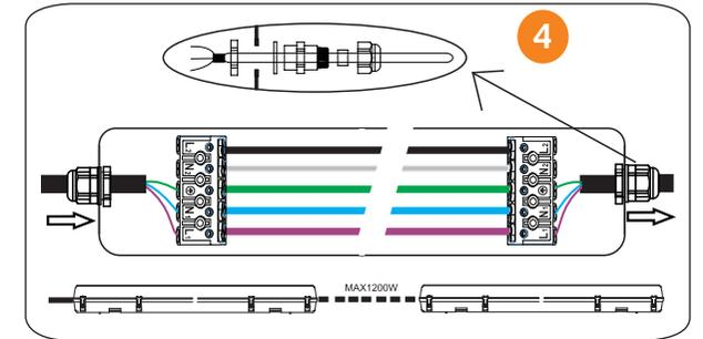
4. Verdrhten Sie das Stromkabel richtig am Klemmblock.
