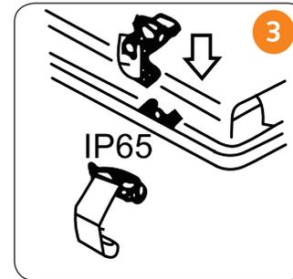
3. Befestigen Sie die Clips bzw. das Seilsystem sicher am Boden der Lampe.
