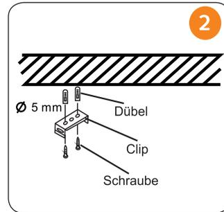
2. Stellen Sie vor dem Bohren sicher, dass keine Kabel bzw. Versorgungsleitungen unter der Bohrung verlaufen. Markieren Sie die Bohrung im richtigen Abstand zur Stromversorgung und montieren Sie die Befestigungsclips bzw. das Seilsystem.
