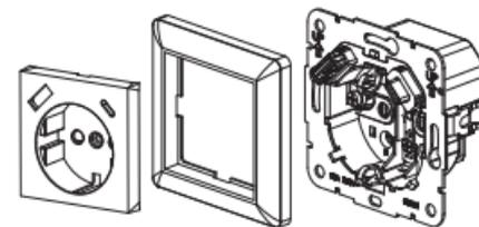
Abschließend montieren Sie den Abdeckrahmen und die Abdeckung. Diese dann noch mit Vorsicht festschrauben.
