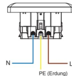
Schließen Sie die Kabel nach obigem Schema an den Klemmen an. Hierbei gilt:
